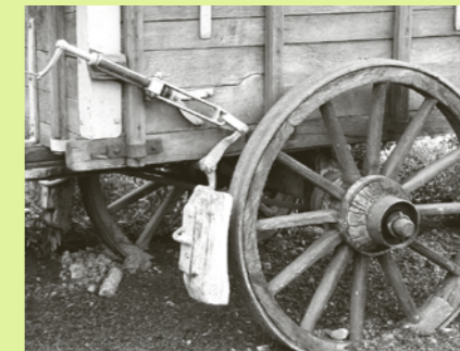
DIE BREMSE DER KUTSCHEN Mit einem Hebel wird der Klotz aus Holz gegen das Rad gepresst.
