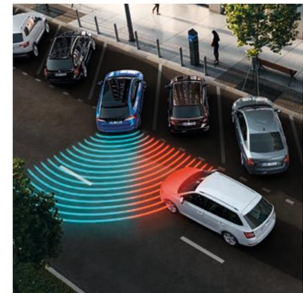
**Assistente per la retromarcia** Questo assistente, che fa parte dell'assistente angolo cieco «Blind Spot Detection» e utilizza gli stessi sensori radar, vi aiuta a uscire in retromarcia in assoluta sicurezza anche in condizioni di scarsa visibilità.
