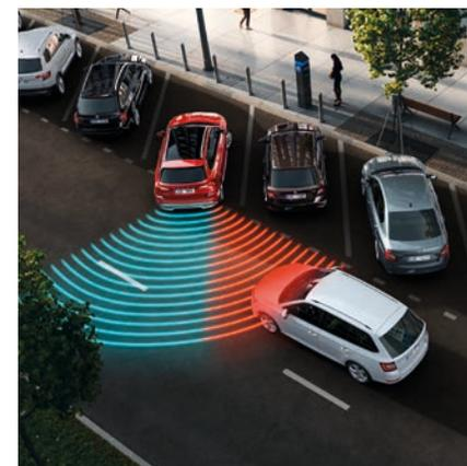
**Assistente per la retromarcia** Questo assistente, che fa parte dell'assistente angolo cieco «Blind Spot Detection» e utilizza gli stessi sensori radar, vi aiuta a uscire in retromarcia in assoluta sicurezza anche in condizioni di scarsa visibilità.
