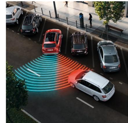
**Système d'assistance au recul** Cet assistant qui fait partie de l'avertisseur d'angle mort «Blind Spot Detection» et utilise les mêmes capteurs radar vous aide, même en cas de mauvaise visibilité, à quitter votre place de stationnement en marche arrière en toute sécurité.
