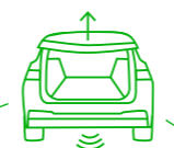
Virtual Pedal, berührungslose Öffnungstechnik der Heckklappe
