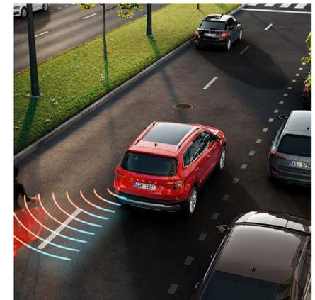
**Spurhalteassistent «Side Assist»** Mit Radarsensoren im Heckstossfänger überwacht «Side Assist» den Bereich hinter und neben Ihrem Wagen und erkennt so andere Fahrzeuge sowie weniger gut erkennbare Objekte, wie etwa Fahrradfahrer, auf eine Entfernung von bis zu 70 m.
