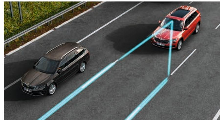
**Spurhalteassistent «Lane Assist»** Der Spurhalteassistent sorgt dafür, dass Ihr Fahrzeug auf der richtigen Spur bleibt. Das System wird über die Multifunktionsanzeige im Cockpit angezeigt.
