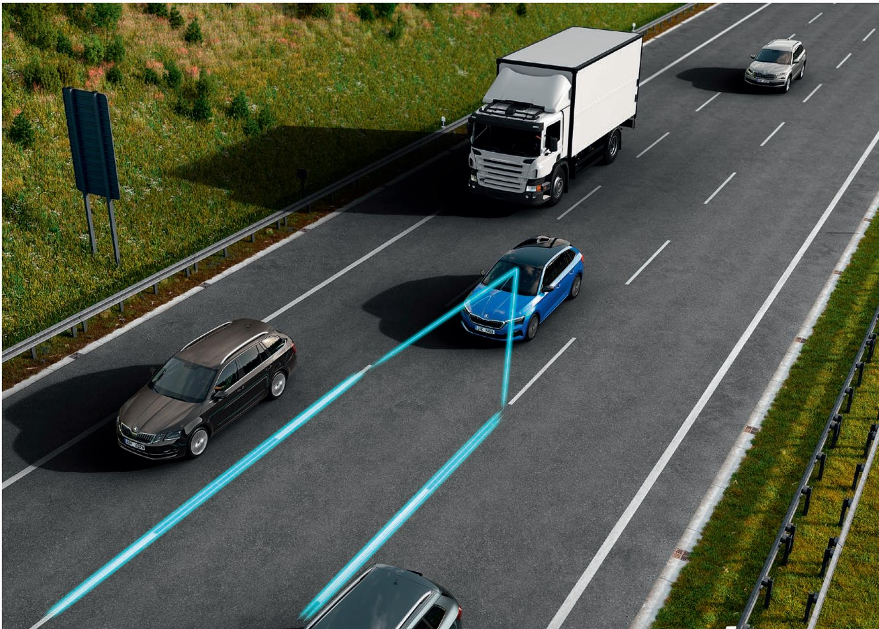
**ASSISTENTE PER IL MANTENIMENTO DELLA CORSIA «LANE ASSIST»**
