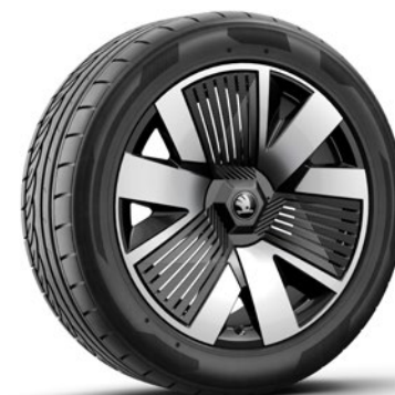
Leichtmetallräder 8,0J | 9,5J x 20" «Kouprey», schwarz glanzgedreht mit schwarzen Aero-Blenden
