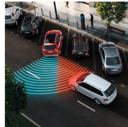
**Système d'assistance au recul** Cet assistant qui fait partie de l'avertisseur d'angle mort «Blind Spot Detection» et utilise les mêmes capteurs radar vous aide, même en cas de mauvaise visibilité, à quitter votre place de stationnement en marche arrière en toute sécurité.
